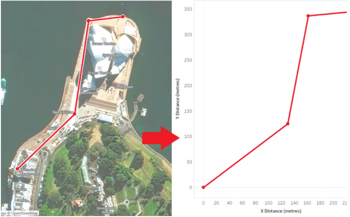
Şəkil 1 GPS sisteminin koordinat oxuna çevrilməsi
